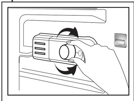
Рабочая температура регулируется соответствующим регулятором.
